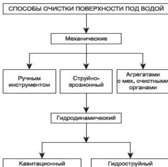
Рисунок 5.2 – Основные механические способы очистки поверхности от обрастания
