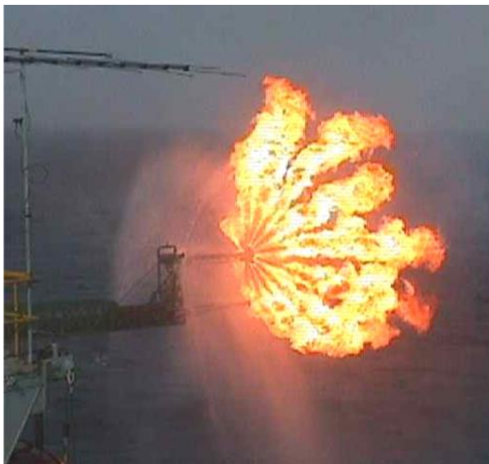
Рисунок 5.1 – Водяной защитный экран факельной горелки
