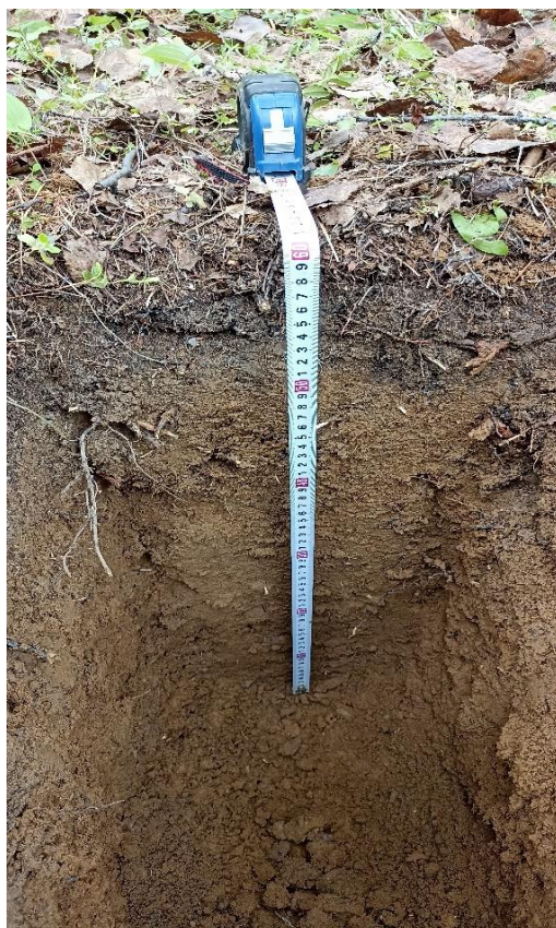
Рисунок 3.3 – Литологический разрез мерзлотной дерново-карбонатной типичной почвы, шурф № 3, трасса автодороги (4 км) к площадке разведочной скважины № 321-112
