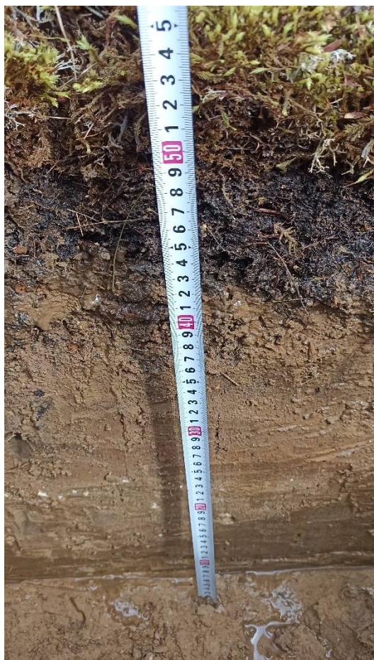
Рисунок 3.7 – Литологический разрез мерзлотной дерново-карбонатной почвы, шурф № 7, трасса водовода к площадке разведочной скважины № 321-112
