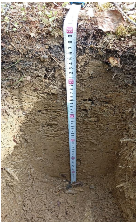
Рисунок 3.2 – Литологический разрез мерзлотной дерново-карбонатной типичной почвы, шурф № 2, трасса автодороги (2 км) к площадке разведочной скважины № 321-112
