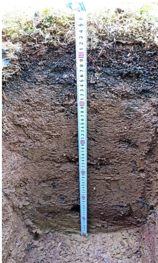
Рисунок 3.5 – Литологический разрез мерзлотной дерново-карбонатной типичной почвы, шурф № 5, северо-восточная часть площадки разведочной скважины № 321-112
