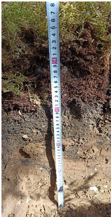
Рисунок 3.6 – Литологический разрез мерзлотной дерново-карбонатной почвы, шурф № 6, западная часть площадки разведочной скважины № 321-112
