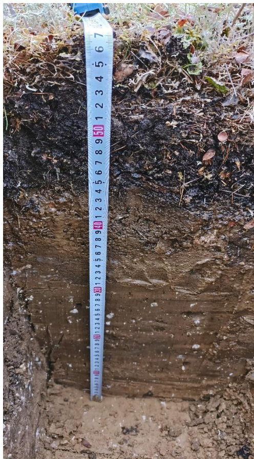
Рисунок 3.8 – Литологический разрез мерзлотной дерново-карбонатной почвы, шурф № 8, водовод
