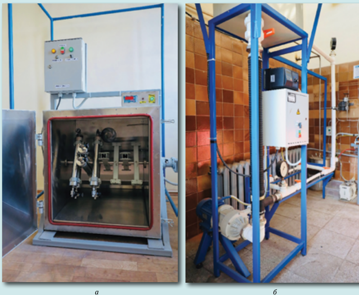
Рис. 1. Внешний вид коррозионных стендов, имитирующих условия: а – переменного смачивания [13]; б – циркуляции жидкости [14].
