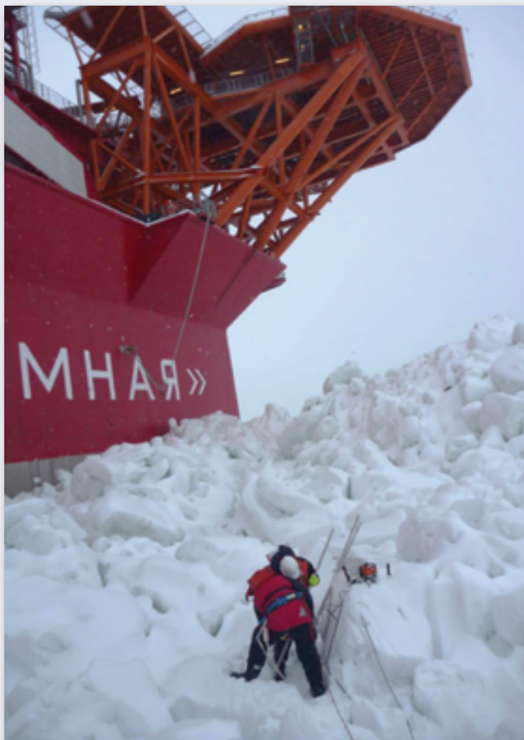
Рис. 5. Определение характеристик ледяного образования у стенки МЛСП «Приразломная» [6]
