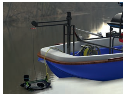
Рис. 1. Надводная часть мобильной телеуправляемой робототехнической плавучей платформы в лодочном исполнении [2]
