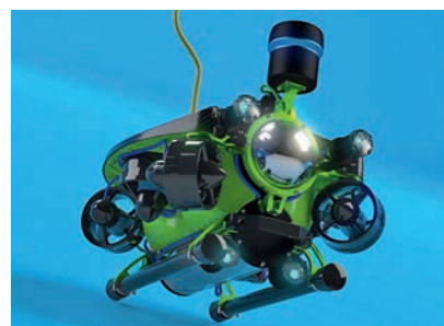
Рис. 2. Подводная часть мобильной телеуправляемой робототехнической плавучей платформы – телеуправляемый необитаемый подводный аппарат [2]
